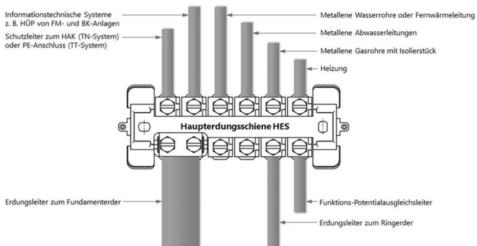
Abbildung: Anschlussbeispiele Haupterdungsschiene
